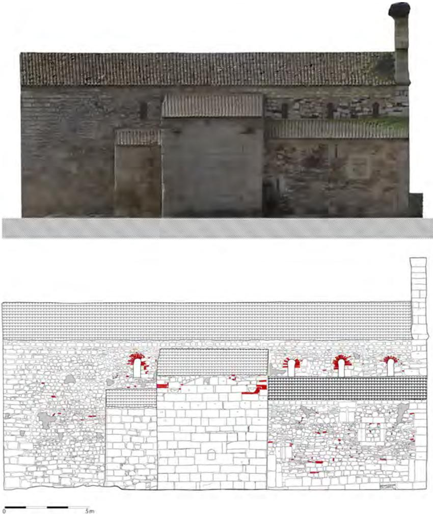
**Figura 15.** Fotogrametría terrestre de la Sé-catedral. Arriba: Ortoimagen de la fachada oriental tomada con dron. Abajo.: Alzado de la fachada oriental dibujado a partir de ortofotografía vertical anterior (© Proyecto IdaVe).
