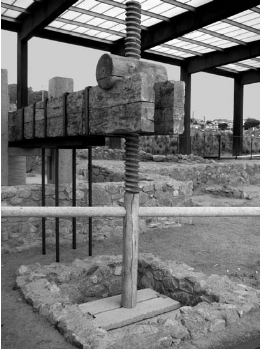
Fig. 8. Reconstrucció in situ de l'aparell d'accionament de la maniobra amb cargol — cochlea — fixat sobre contrapès monolític a Vallmora (Teià, Maresme, Barcelona) (Martín i Oliveras, 2009).
