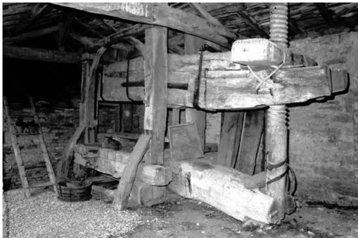
Fig. 23. Premsa de biga amb estructura travada localitzada a Domaine du Vernay a Mazille, Saône-et-Loire (J.L. Duthu © Inventaire général, ADAGP, 2001) (Lauvergeon, 2004: 20, fig. 20).
