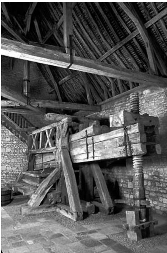
Fig. 24. Premsa de biga amb contrapès fixat al terra localitzada a Clos de Vougeot, Côte-d'Or, Bourgogne (J.L. Duthu © Inventaire général, ADAGP, 2003) (Lauvergeon, 2004: 6, fig. 4).
